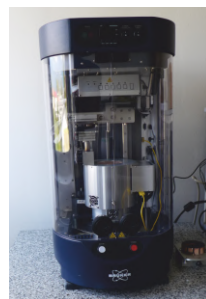
Vysokoteplotný tribometer na testovanie odolnosti vrstvy. Testovaná vzorka sa vybreje na vysokú teplotu a dlhodobým otieraním hrotu o povrch sa spôsobuje jej opotrebenie. To sa vyhodnotí optickým profilometrom.
